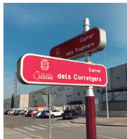
Señales de dirección de acero esmaltado en blanco y rotuladas con vinilo
